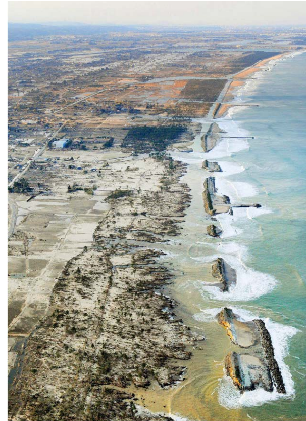
津波で防波堤が寸断され海水が流れ込む宮城県山元町の海岸(3月19日)=共同
