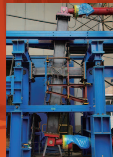
鋼構造骨組の実大載荷実験
