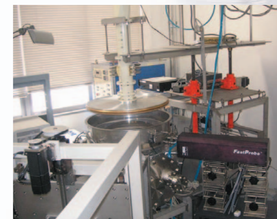
マルチスロットアンテナ・マイクロ波プラズマ源
