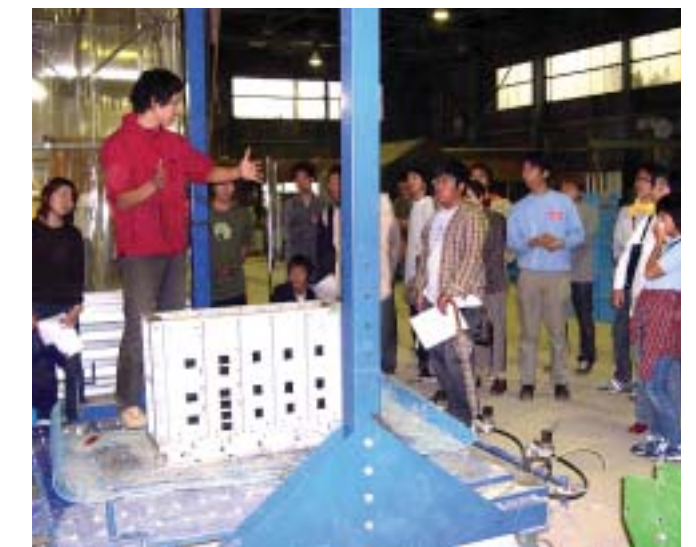
振動台による液状化試験
