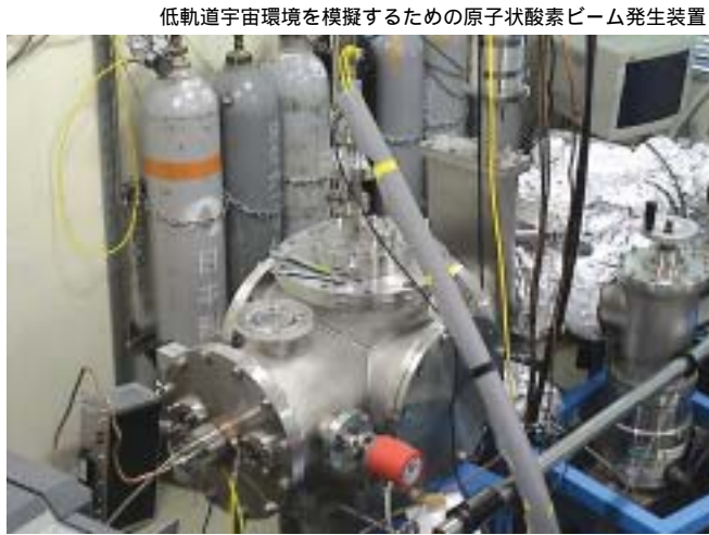
低軌道宇宙環境を模擬するための原子状酸素ビーム発生装置
